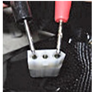
Figure 40: Using a DC Volt Meter
